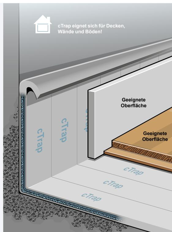
**BEACHTEN SIE BITTE:** Das cTrap-Vlies ist mit der rauen („flauschigen“) Seite zur Emissionsquelle hin zu verlegen. Nach der Montage des Vlieses muss also der Text „cTrap“ sichtbar sein. Das cTrap-Vlies ist unmittelbar nach der Montage mit der Deckschicht zu versehen. Für das bestmögliche Ergebnis sollte cTrap auch nach der Montage trocken gehalten werden.
